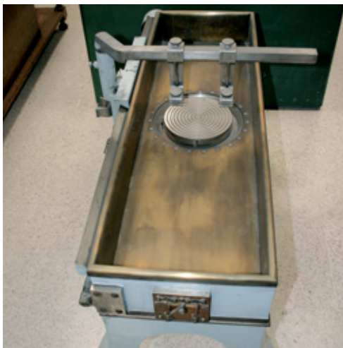
Microtomo panorgánico diseñado en el Laboratorio de Automática.
