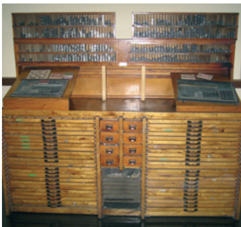
Chivalete para composición tipográfica (derecha) y linotipia (izquierda).
