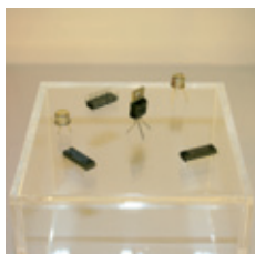
Componentes electrónicos: válvulas de vacío (izquierda), transistores y circuitos integrados (centro) y transistores MOS (derecha).
