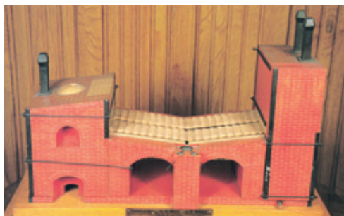
Vista de la torre de acceso a la mina "Marcelo Jorissen" (arriba) y maqueta de un horno de aludeles de Almadén (abajo).
