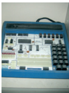
Sistema de aprendizaje para manejo de microprocesadores.
