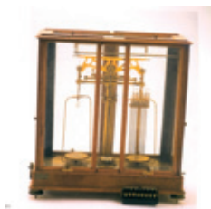
Balanza de precisión y pesas patrón de cuarzo.
